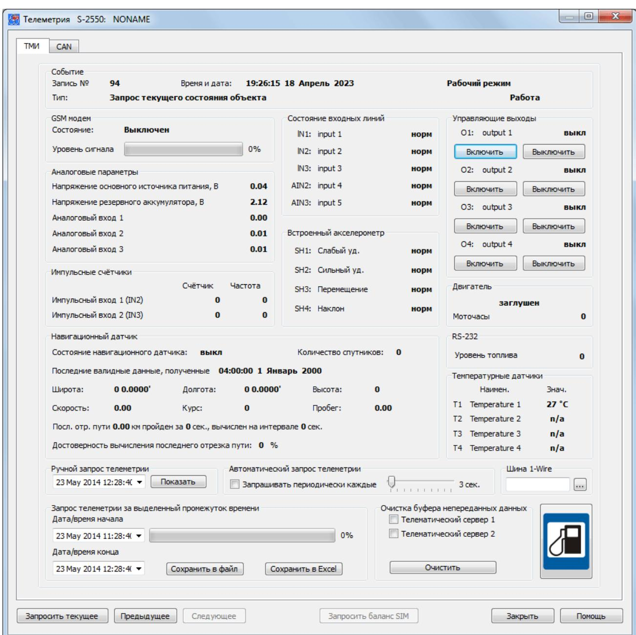
Рис. 556. Окно просмотра текущей телеметрии и управления устройством. Вкладка «TMI» (для устройства S-2550)
