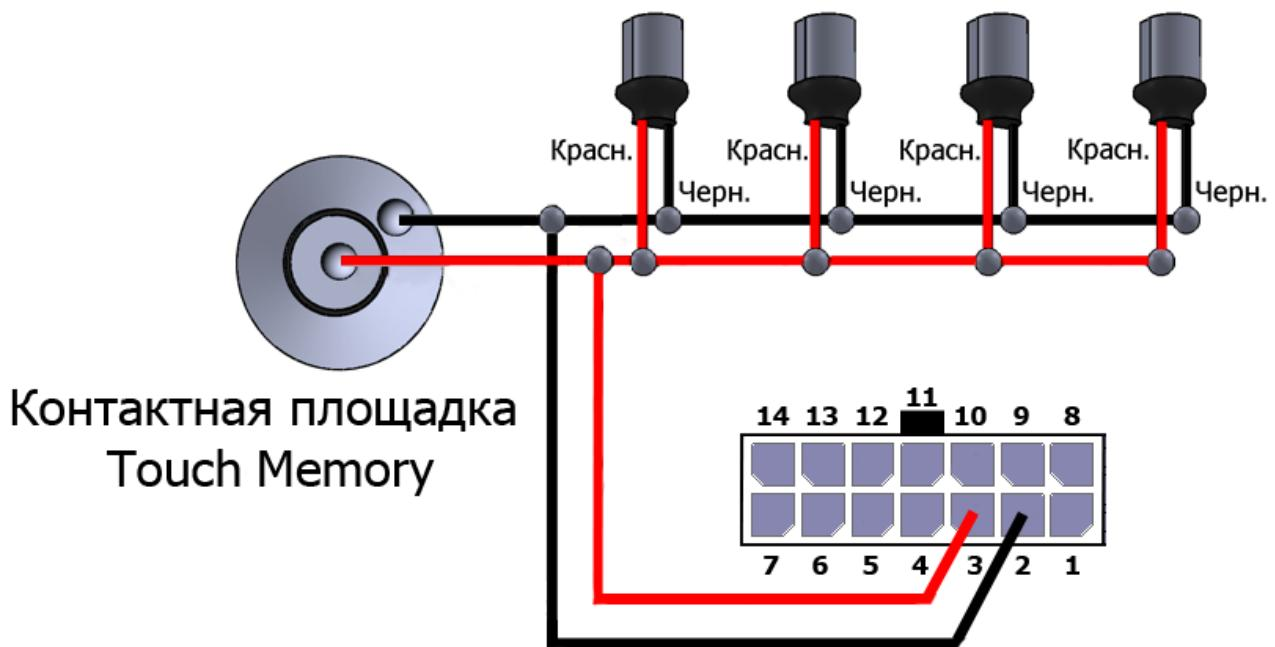
Рис. 44. Подключение цифровых датчиков температуры и контактной площадки Touch Memory
