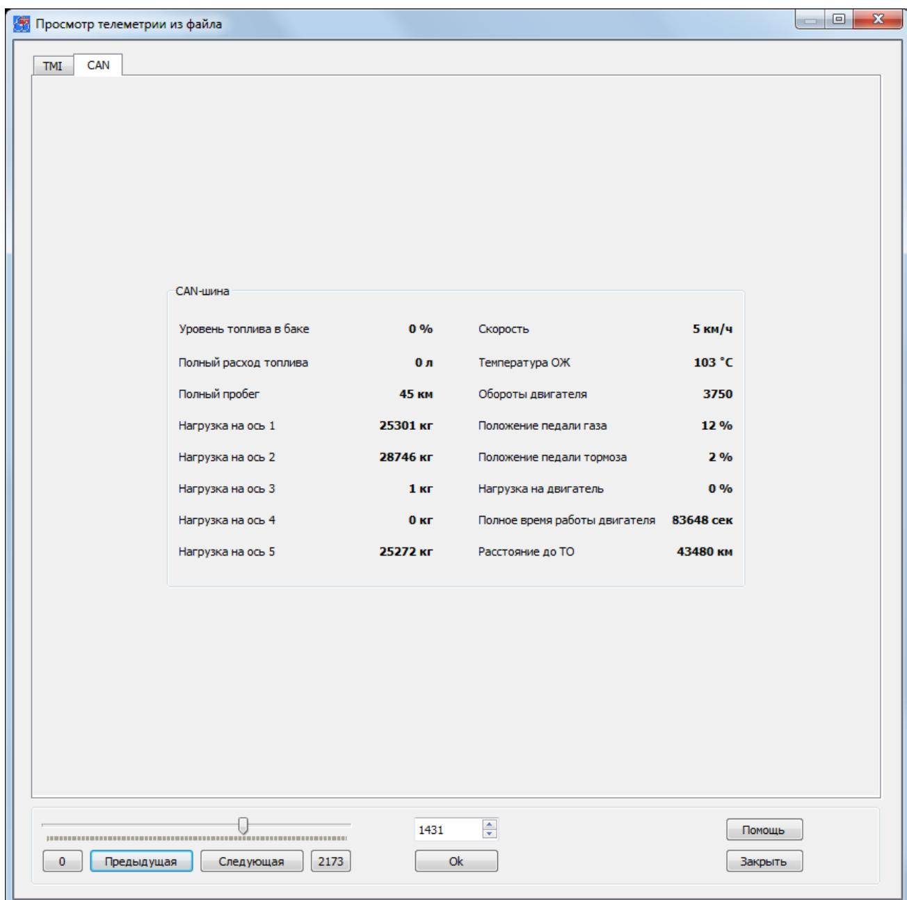
Рис. 576. Окно просмотра телеметрии в постраничном виде. Вкладка CAN
