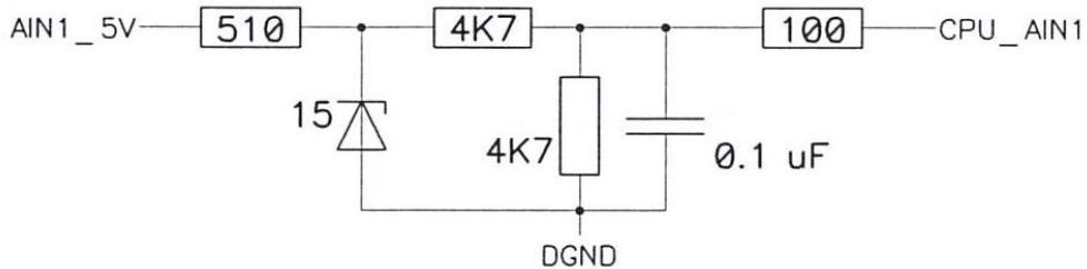
Рис. 33. Принципиальная схема аналогового входа AIN1 устройств СИГНАЛ S-2550, S-2551, S-2552
