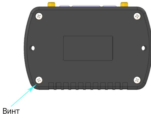
Рис. 25. Снятие задней крышки корпуса устройства
