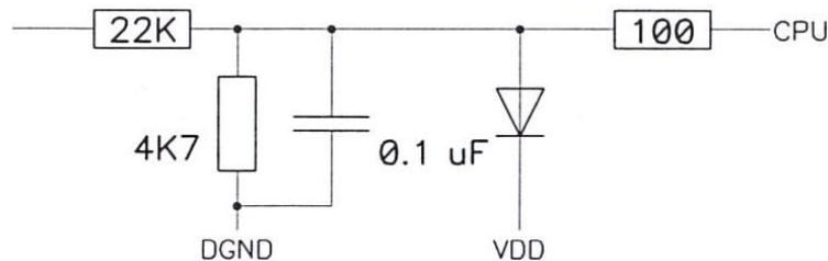
Рис. 34. Принципиальная схема аналоговых входов AIN2 и AIN3 устройства СИГНАЛ S-2550, S-2551, S-2552
