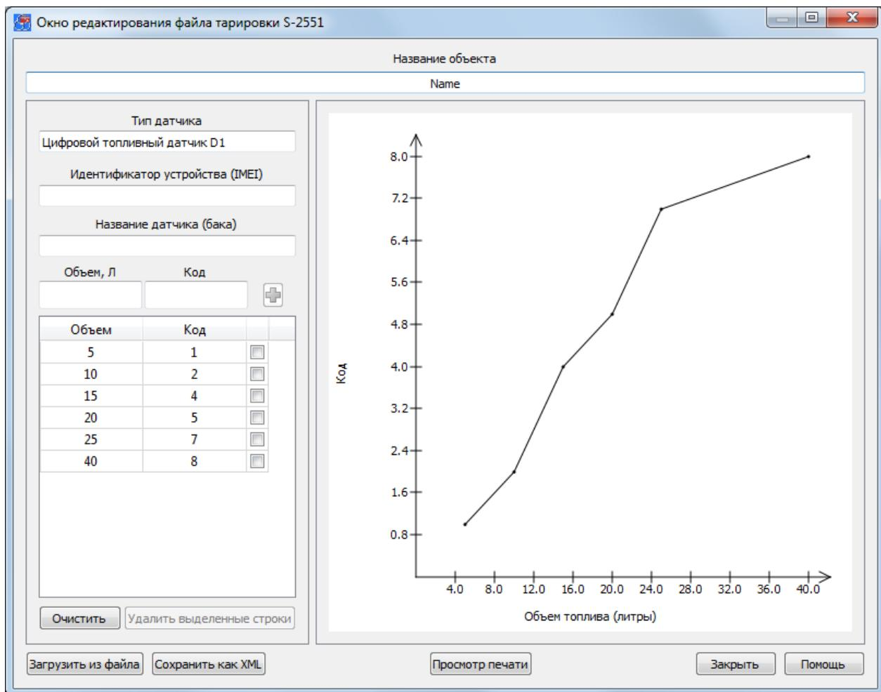
Рис. 76. Окно редактирования файла тарировочной таблицы
