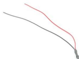
Рис. 42. Термодатчик на основе микросхемы DS18S20
