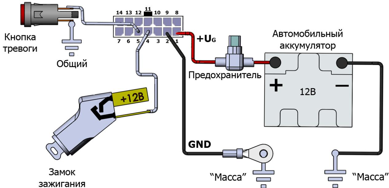
Рис. 32. Схема подключения замка зажигания и тревожной кнопки
