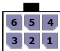
Рис. 22. 6-контактный разъем последовательных коммуникационных интерфейсов
