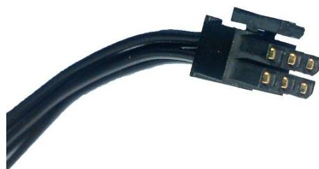
Рис. 8. 6-контактный кабель (жгут) типа Microfit-6
