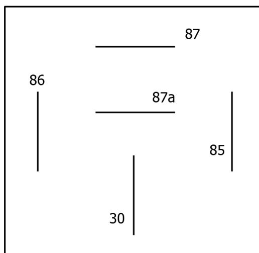
Рис. 37. Обозначение контактов внешнего реле
