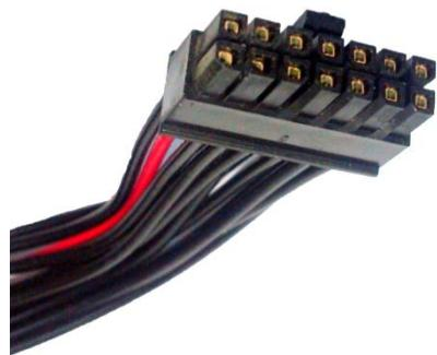
Рис. 7. 14-контактный кабель (жгут) типа Microfit-14
