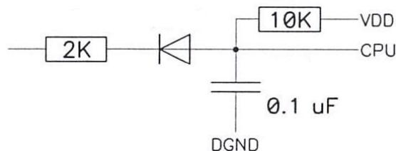
Рис. 31. Принципиальная схема входов IN2, IN3 устройств СИГНАЛ S-2550, S-2551, S-2552
