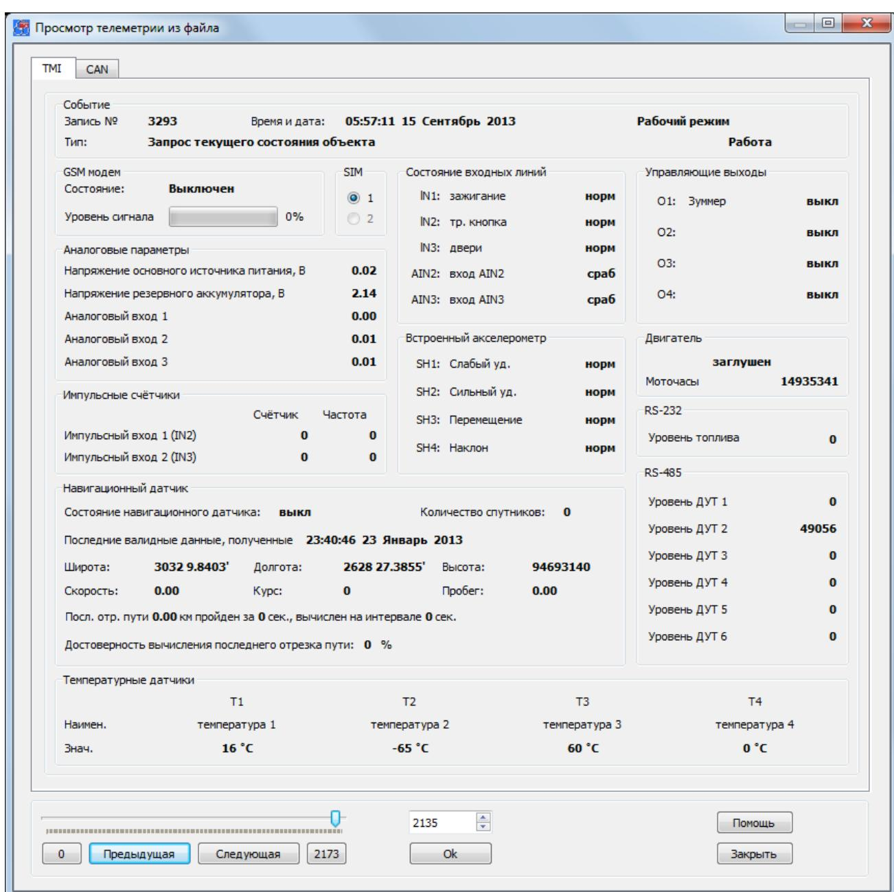
Рис. 57а. Окно просмотра телеметрии в постраничном виде. Вкладка TMI
