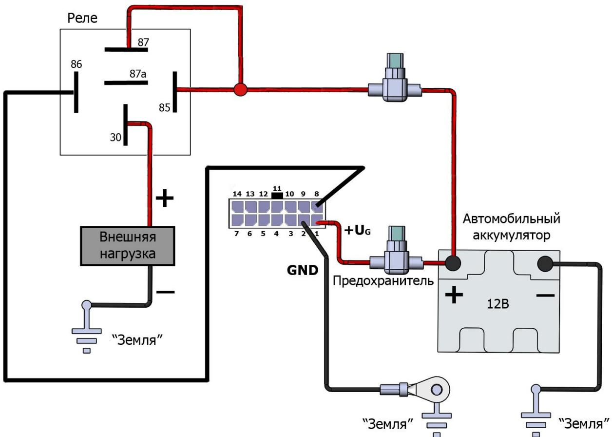
Рис. 39. Схема подключения реле к выходам устройства O1, O2, O3, O4
