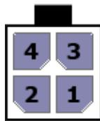
Рис. 23. 4-контактный разъем интерфейса громкой связи
