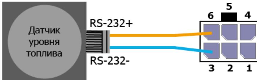
Рис. 47. Схема подключения датчика уровня топлива по интерфейсу RS-232
