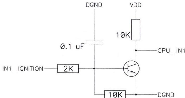
Рис. 30. Принципиальная схема входа IN1 устройств СИГНАЛ S-2550, S-2551, S-2552
