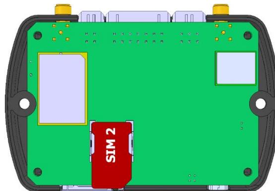
Рис. 27. Установка второй SIM-карты в устройство
