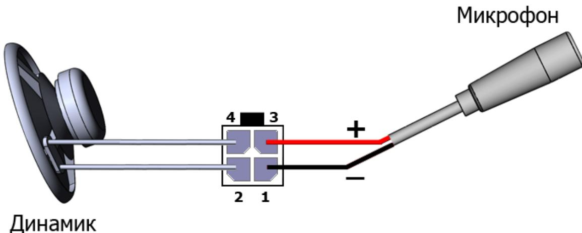
Рис. 48. Подключение динамика и микрофона
