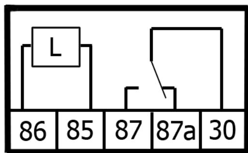
Рис. 38. Схема пятиконтактного реле
