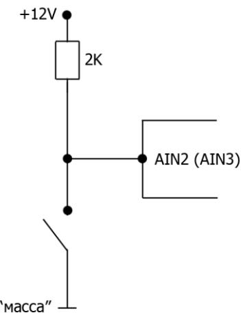
Рис. 35. Схема подключения контактного датчика к входам AIN2 и AIN3 при замыкании на «массу»
