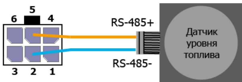
Рис. 46. Схема подключения датчика уровня топлива по интерфейсу RS-485
