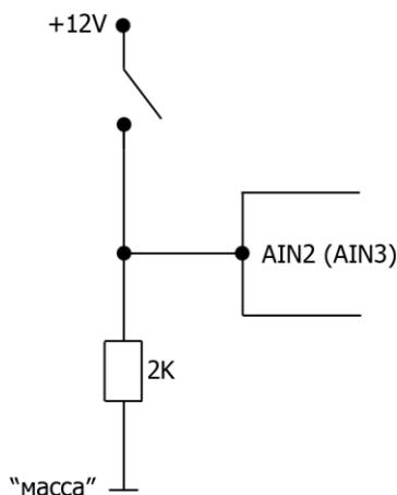
Рис. 36. Схема подключения контактного датчика к входам AIN2 и AIN3 при коммутации с положительным потенциалом
